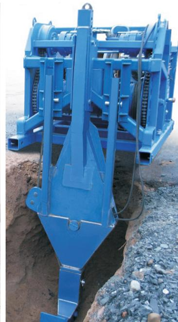
Единый блок с лебедкой серии HVY, используется как при ремонте трубопровода, так и в тяжелых условиях эксплуатации.
